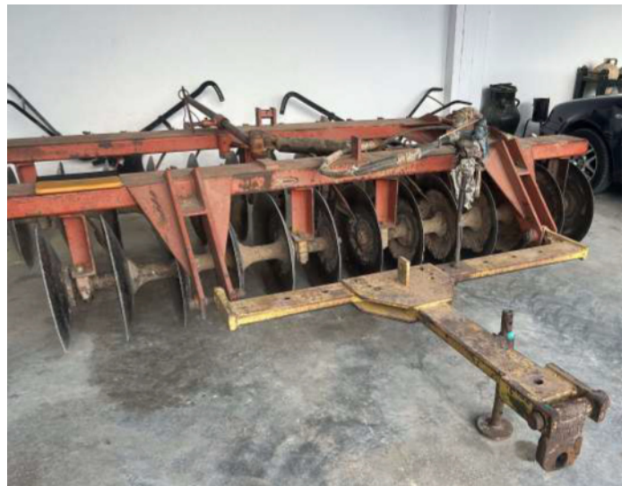
Grada de discos acoplada al tractor en el momento del accidente. El trabajador se disponía a ayudar en el desacoplamiento del apero.
