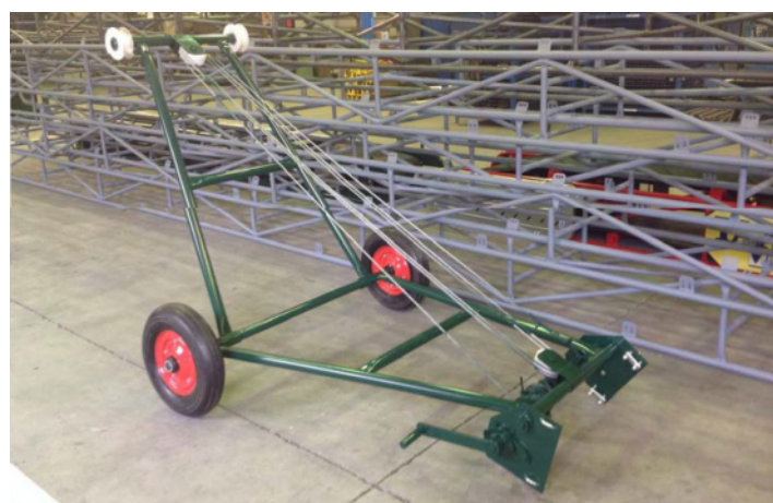
Pie de rodaje que soporta la cinta transportadora
