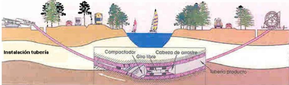
Figura 55. Instalación de tubería
