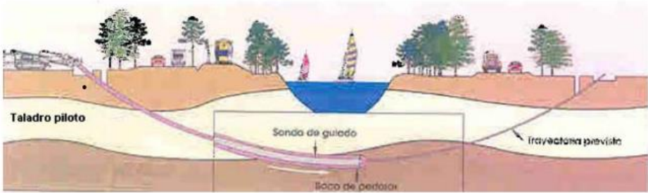
Figura 53. Perforación de piloto
