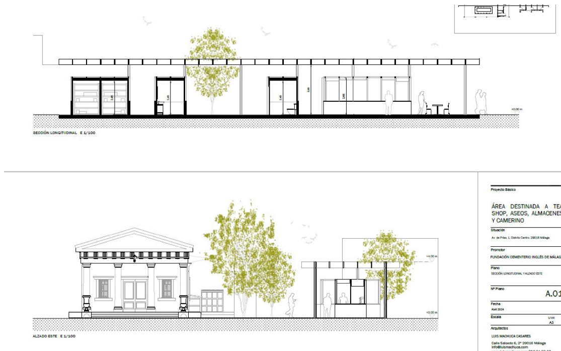
Figura n.º 3: Alzado de las edificaciones.
