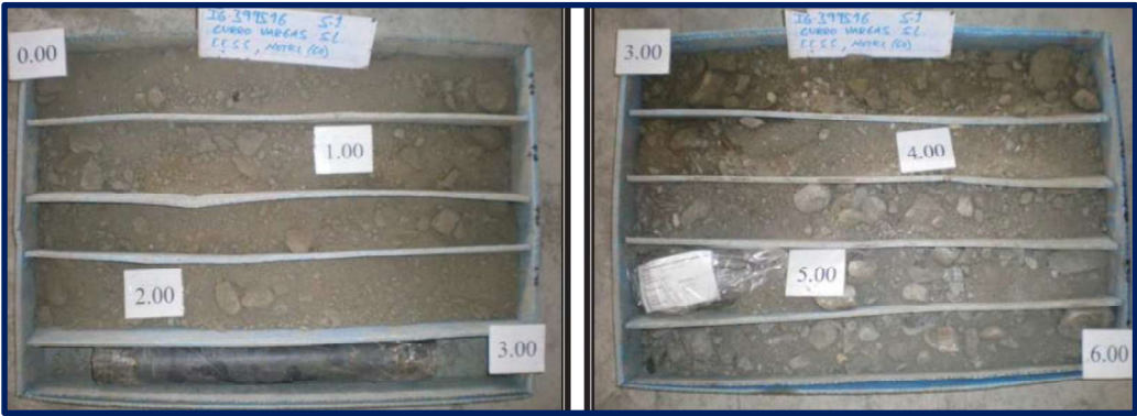
Testigos del sondeo S-1 en la estación de servicio Las Jareas
