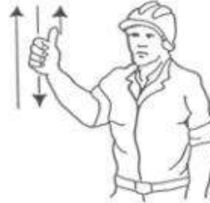
4 Levantar el aguilón o pluma lentamente
