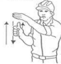
4 Levantar el aguilón o pluma lentamente
