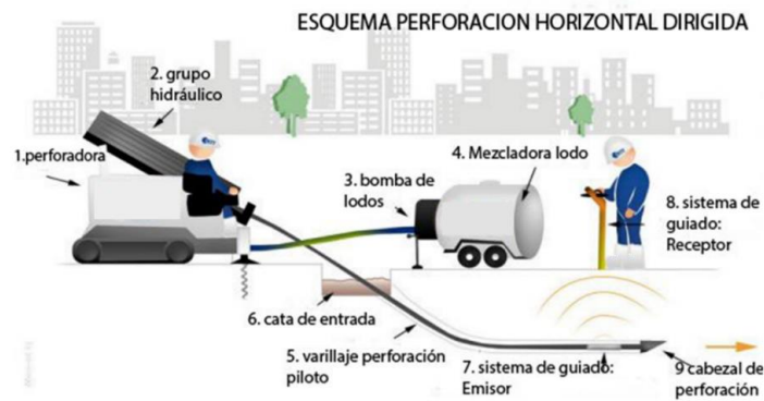
Imagen 2. Maquinaria utilizada en la perforación horizontal dirigida.
