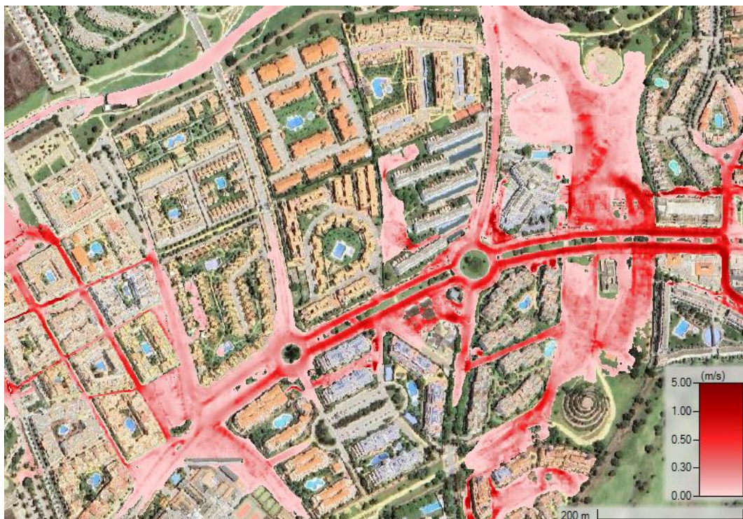
Figura 19. Ejemplo de velocidades obtenidas en la modelización del tramo ES63- ARPS-0056 para T100.
