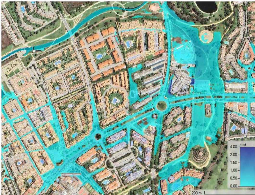
Figura 18. Ejemplo de calados obtenidos en la modelización del tramo ES63- ARPS-0056 para T100.
