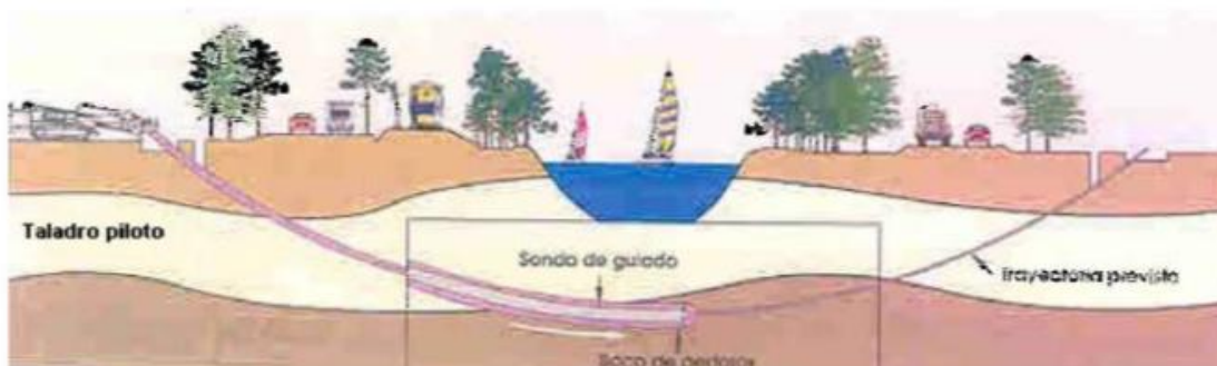
Ilustración 25. Esquema del proceso de perforación piloto.
