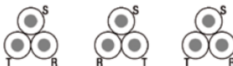
Ilustración 46. Colocación de cables en tresbolillo
