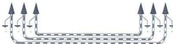
Ilustración 47. Puesta a tierra cubiertas metálicas
