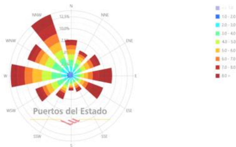
Rosa de Velocidad Media (m/s) para Viento - Boya de Golfo de Cádiz Periodo: 2014 - 2024 - Eficacia: 94.33%
