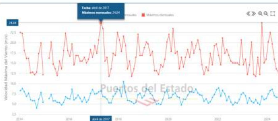
Figura 18. Velocidad de viento media y máxima (2014-2024). Boya del Golfo de Cádiz. Fuente: Puertos del Estado.
