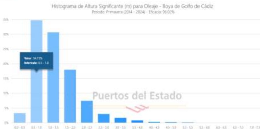
Figura 28. Histograma de altura significativa de ola. Primavera (2014-2024). Boya del Golfo de Cádiz. Puertos del Estado.
