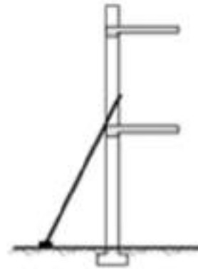
USAR ZAPATAS ANTIDESLIZANTES
