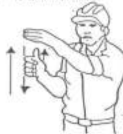
4 Levantar el esquilón o pluma lentamente
