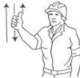
4 Levantar el esquilón o pluma lentamente
