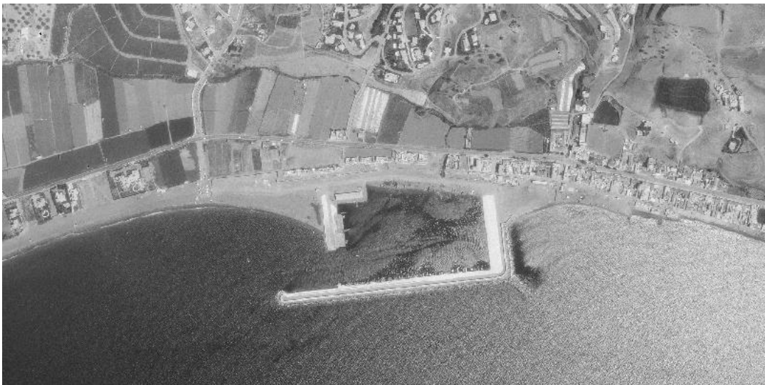
El puerto en construcción, julio 1977. Obras de abrigo y primeras edificaciones de servicio a la pesca. Fotografía aérea IGN
